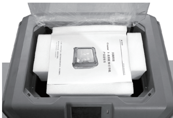
6. 移除固定顶部的胶带，打开顶盖。
