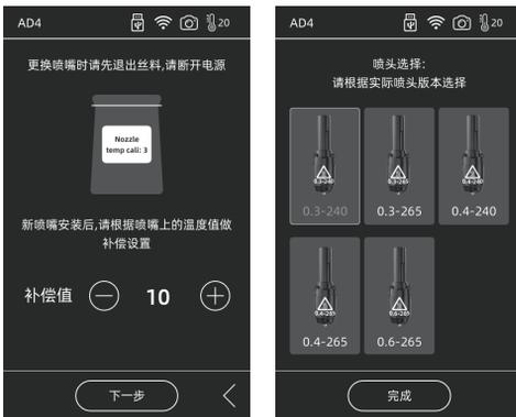
安装新喷嘴后，请根据所换喷嘴的温度值做补偿值设置；喷头实际偏差范围：-10~30。点击下一步进入选择喷头界面。选择所安装的新喷嘴，预热中会根据选择的喷嘴类型而设定最高温度。请确保安装的喷嘴与选择的喷嘴类型一致，点击完成回到维护界面。
