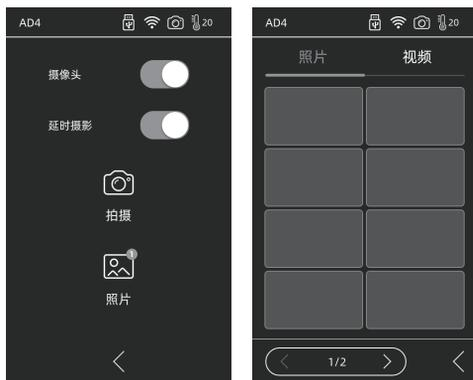
**相机**：可进行远程查看；开启摄像头，开启延时视频时，在打印过程中将会录制延时视频，存储在内存中；可在照片中查询。点击拍摄，将会拍摄当前画面以照片形式存储。
