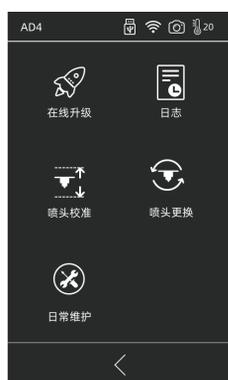
设备出厂经过调平校准，但由于运输等情况，喷嘴与平台间距可能发生变化，建议在开箱后进行一次【喷头校准】。
