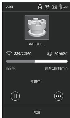
将stl或obj文件导入到切片软件中；进行切片，软件切片完成后，打印机进行加温等工作，准备完成后自动开始打印。
