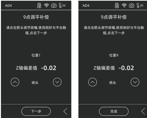
**调平校准：**包含了喷头校准以及9点调平补偿功能
